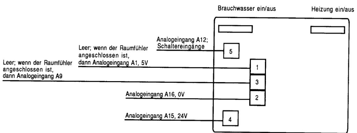
Achtung: Beim falschen Verdrahten der 24V, 5V, 0V und Analogeingänge kann die OSIRIS - Steuerung erheblichen Schaden erleiden. Die Funktionsfähigkeit kann nicht mehr gewährleistet werden.
